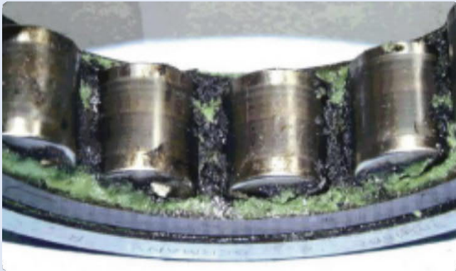
由於通過電流引起的潤滑效能下降
